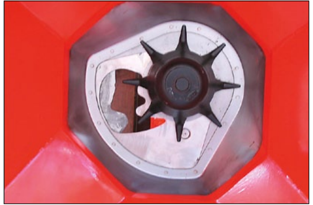
Az AXIS speciális formájú adagolónyílása
