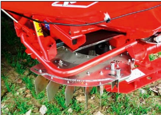
Telimat szóróhatároló a munkaszélesség korlátozásához
