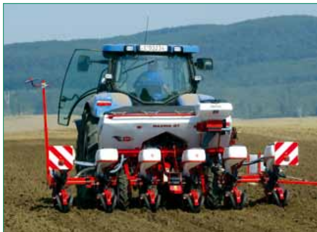
Kuhn Maxima GT tartállyal, a műtrágya kapacitás így 950 vagy 1350 liter lehet
