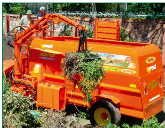
Hulladék feldolgozása beépített motorral és saját daruval szerelt géppel
