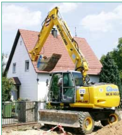
A New Holland MH Plus mobil kotrógép ideálisan használható a szűk helyen való építkezéseken
